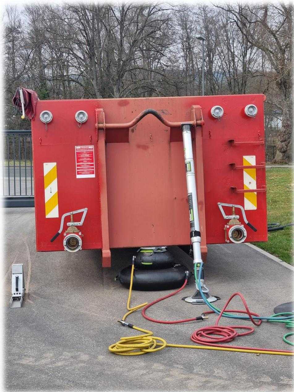
Anhand des Bildes ist gut zu erkennen, welche Vorteile die Hebekissen der Firma **RESQTEC** vorweisen. Die Hebekissen (bis zu 3 Stück) können miteinander verschraubt werden, dass stellt es im Vergleich zu herkömmlichen Hebekissen eine höhere Sicherheit dar und bietet einen deutlich stabileren halt. Des Weiteren gibt es bei diesem Satz Hebekissen den Vorteil, dass es eine „Stützplatte“ gibt, welche verhindert, dass das zutragende Objekt direkt auf der Gummierung aufliegt.
